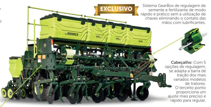
Linhas Dianteiras: Versáteis, altas, desencontradas (330mm), fixas de modo intercalado nos 2 tubos inferiores do chassi com diversas opções de discos corte e depositores de fertilizante. O conjunto de molas foi projetado e posicionado para gerar pressão constante sobre os discos de corte e na linha do fertilizante, proporcionando mais estabilidade.
